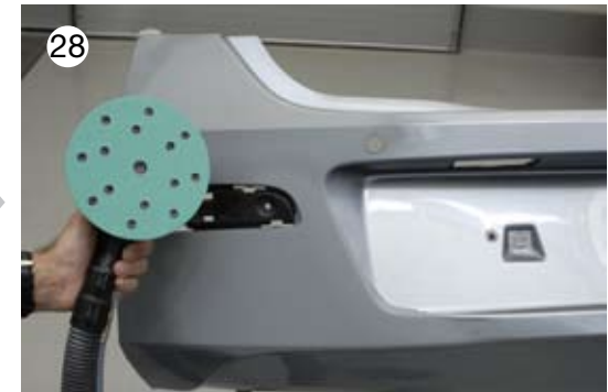
→ Ponçage de l'apprêt avec P400
